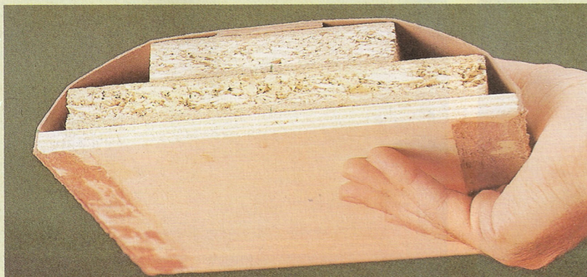
Per la costruzione del condotto di accordo del Microsub, si sono impiegati tre pannelli di legno (truciolare e multistrato) e cartone, tagliati secondo le dimensioni fornite dal Vent-PC (in alto). I pannelli sono poi stati uniti, mediante incollaggio, in modo da far coincidere i loro centri. Il sandwich così ricavato è stato poi rivestito con del cartone da 1 mm di spessore, incollato dapprima alla parte centrale e poi a quelle laterali (in basso).
