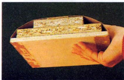
Figura 13 - In questa foto si vede come va «costruito» il condotto di accordo esponenziale. Dapprima si uniscono i pezzi B, F e G, centrandoli bene, poi si incollano su di essi i pannellini H, in cartone da 1 mm, alti 20 cm e larghi 5 cm. Alla struttura così ottenuta si fissa poi il pezzo I, anch'esso in cartone. Quando la colla ha fatto presa si dovranno flettere i lembi del cartone in modo da lasciare tutti i pannelli, fino a raggiungere il pezzo B al quale vanno incollati.
